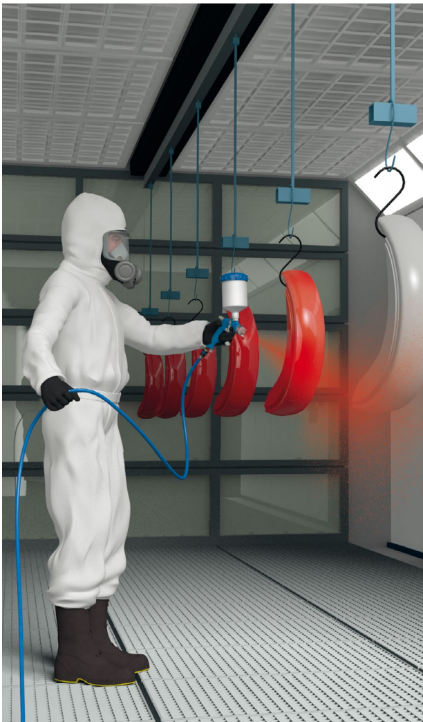
Abb. 1: Für Arbeiten in der Spritzkabine sollten Werkstücke nicht höher als in Brusthöhe angeordnet werden.
