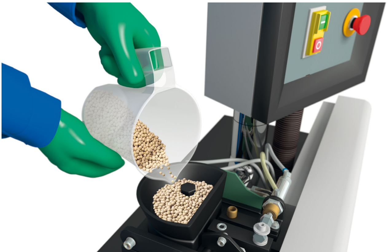
Abb. 8: Geeignete Schutzhandschuhe verhindern den Hautkontakt mit festem Schmelzkleber
