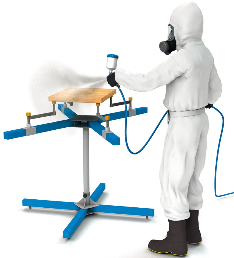
Abb. 2: Der Drehtisch ermöglicht, dass die arbeitende Person nicht in den Bereich des abgesaugten Sprühnebels tritt.
